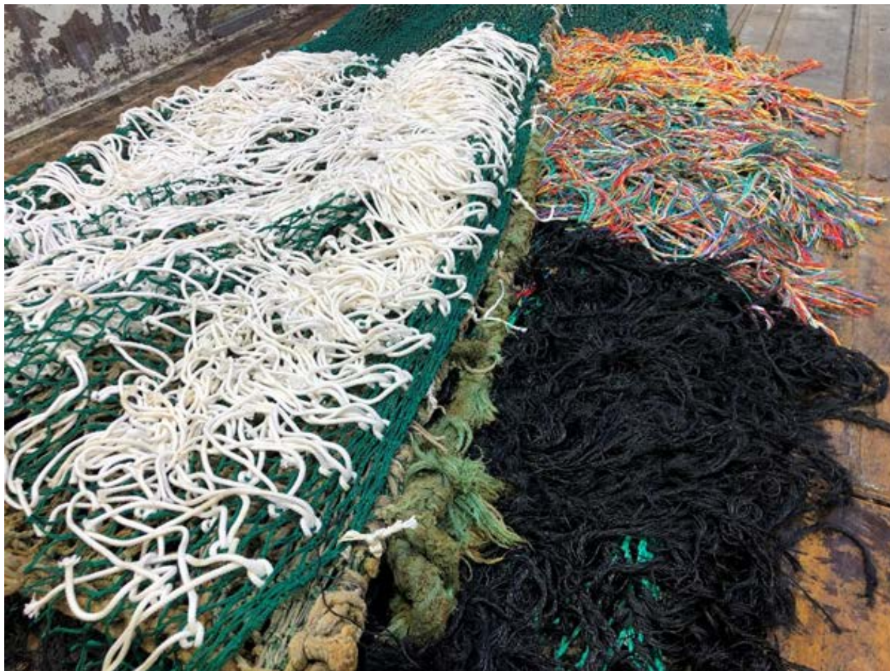
Bilde 17. Labbetuss av trefibertau (hvitt) og vanlig labbetuss laget av polyetyldtau (sort og farget) før forsøkene starter. Labbetuss er en slitematte som beskytter trålsekkene mot riving i bunnen (Bilde: Simon Eliseussen/Jørgen Vollstad).
