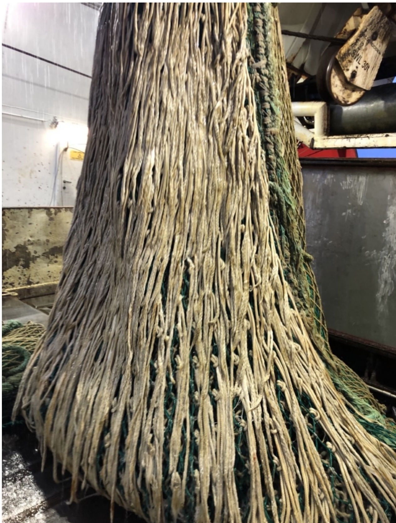
Bilde 20: Labbetuss med trefibertau etter 43 hal (Bilde: Simon Eliseussen).
