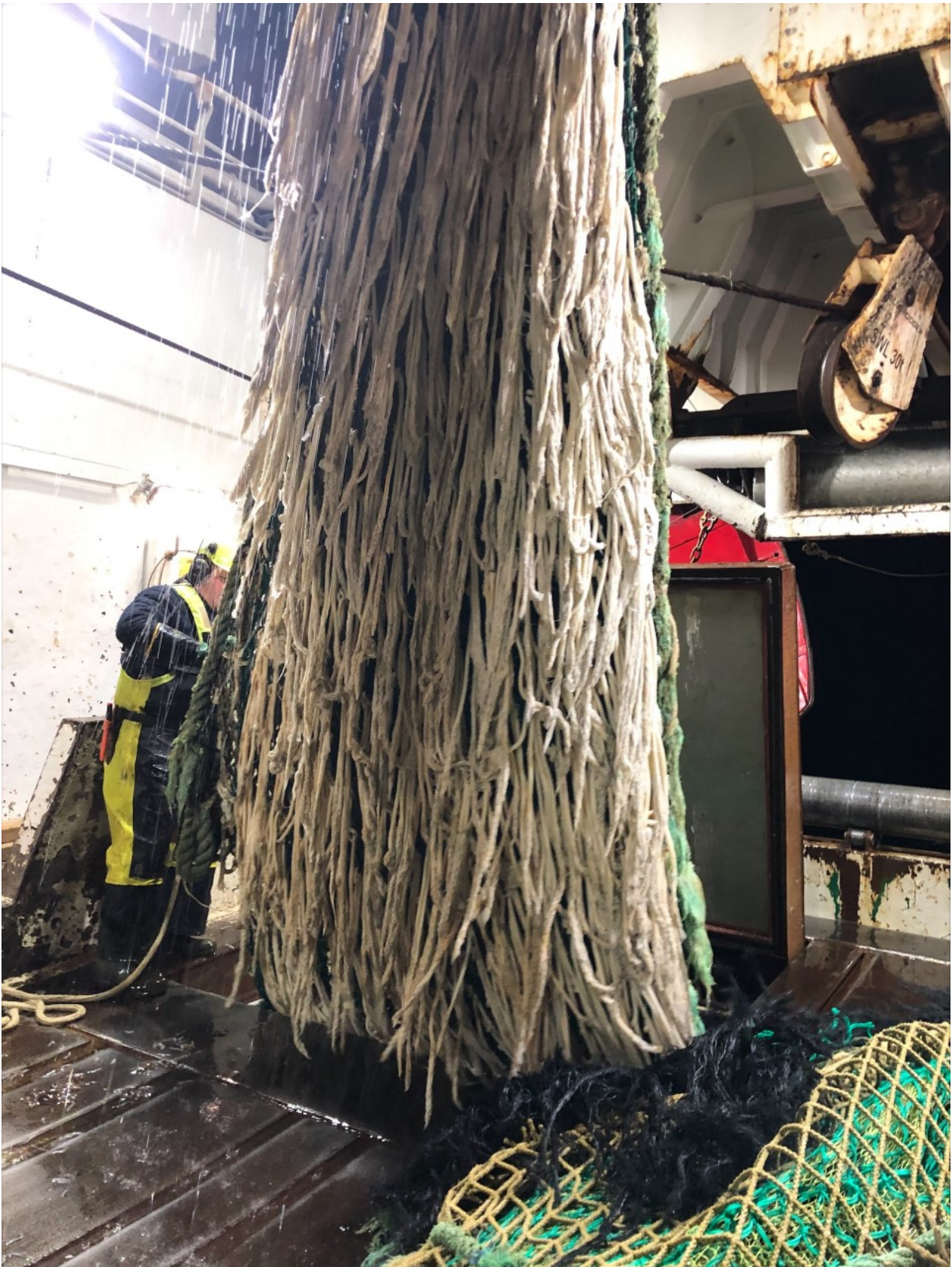
Bilde 19: Labbetuss med trefibertau etter 12 hal (Bilde: Simon Eliseussen).
